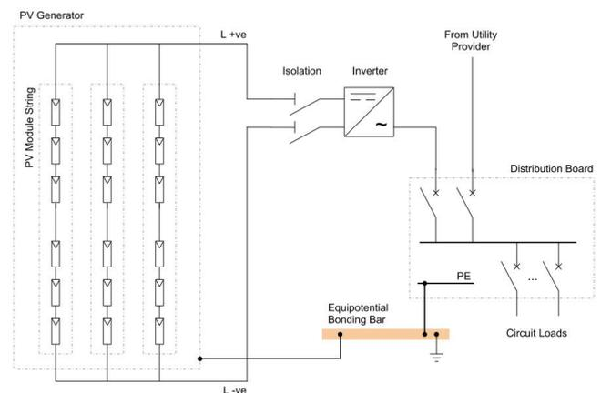
FIG III PV SYSTEM SINGLE LINE DIAGRAM
