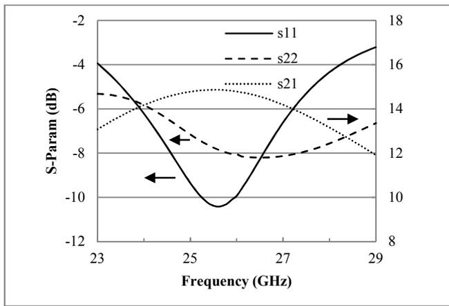
Fig. 8. LNPA S-Parameters
